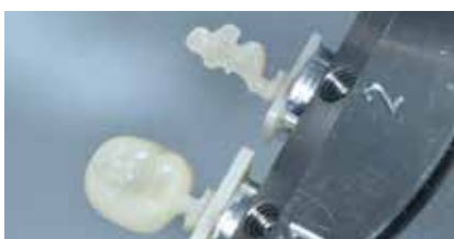
Il restauro dopo il completamento della fresatura
