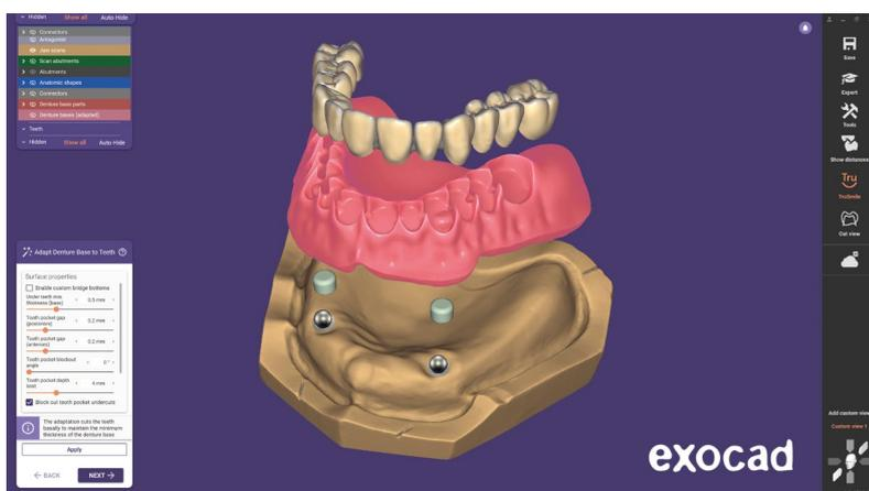
Il software di exocad, *DentalCAD* ed *exoplan* per la pianificazione implantare, sono integrati in modo perfetto. È possibile progettare e produrre protesi totali snap-on su impianti in fase preoperatoria per il carico immediato.
