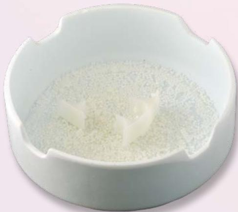
Residui di zirconia ad alta trasparenza bianca all'interno del vassoio su perle di sinterizzazione per la decontaminazione del forno.
